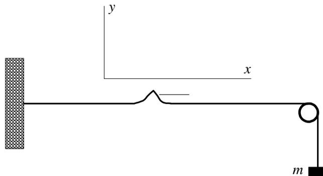
Schéma de la corde : l'extrémité de gauche est fixée à un mur, celle de droite passe sur une poulie et supporte une masse, ce qui permet de considérer que la tension de la corde est constante et égale à  $mg$ .
